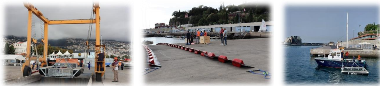
Figura 5 – Equipamentos utilizados pela APRAM para a recolha de resíduos – à esquerda, cesto de recolha; ao centro, barreiras flutuantes; à direita, embarcação Ancoreta.
